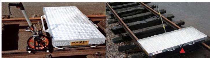
**Plateaux de transport manuels doubles** accouplés avec freins automatiques
